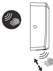
Moguće je podešiti opseg senzora pomoću senzora VR koji se nalazi na programskoj PCB (pogledajte odjeljak 8 u „INSTALACIJI”).
