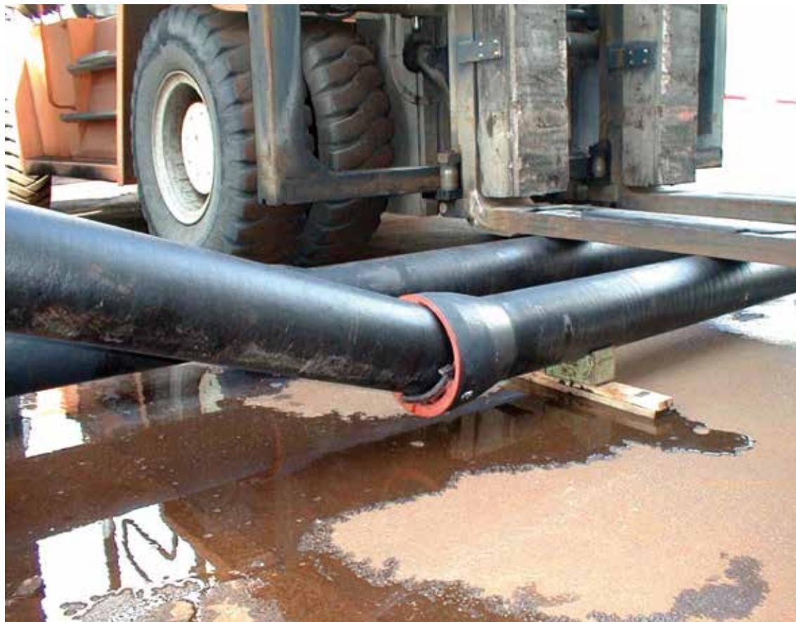
Ispitivanje odstupanja: čuva spoj do 24°
